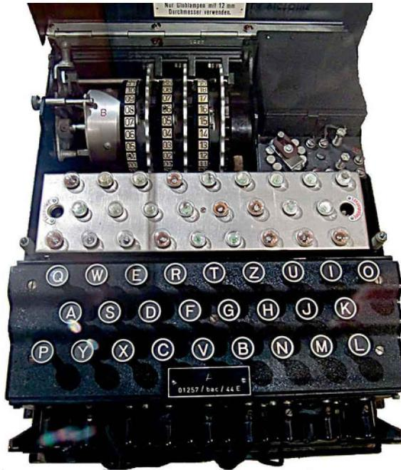
**FIGURE 1.11.** La machine Enigma : cette vue ouverte de la machine Enigma fait apparaître les trois rotors ainsi que les lampes qui indiquent la lettre qui se substitue à celle qui est actionnée sur le clavier.
